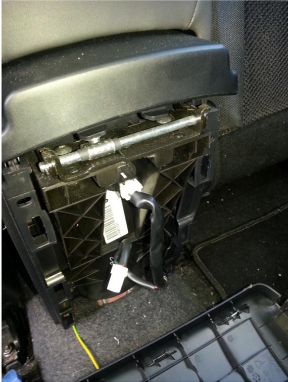
An der Rückseite der Mittelkonsole gibt es Strom. Die Abdeckung kann entfernt werden, indem man unten unter den Deckel greift und zieht. Der Deckel ist nur geschnappt. Der Stecker unten führt einen Dauerplus und einen geschalteten Plus sowie einen Minus.
