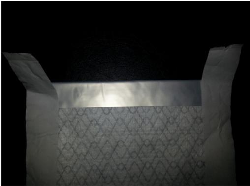
Nun habe ich die Heizung in den oberen Sitz eingeschoben, mit dem Klebeband nach unten. (noch nicht abgezogen) Nachdem die Heizung gut lag, habe ich das Klebeband abgezogen. Das ist relativ einfach. Das Kabel auf die Seite legen, wo auch der Airbag ist.
