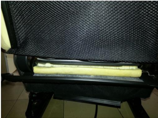
Man kann nun den unteren Stoff mit Auflage entfernen. Es lässt sich dann leichter die Heizmatte in den oberen Sitz einfügen.
